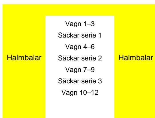
Figur 1. Stukans uppbyggnad på Övedskloster. Efter att stukan fyllts sattes balar även vid den nedre kortsidan så att hela stukan omsluts av 1 m breda storbalar.
