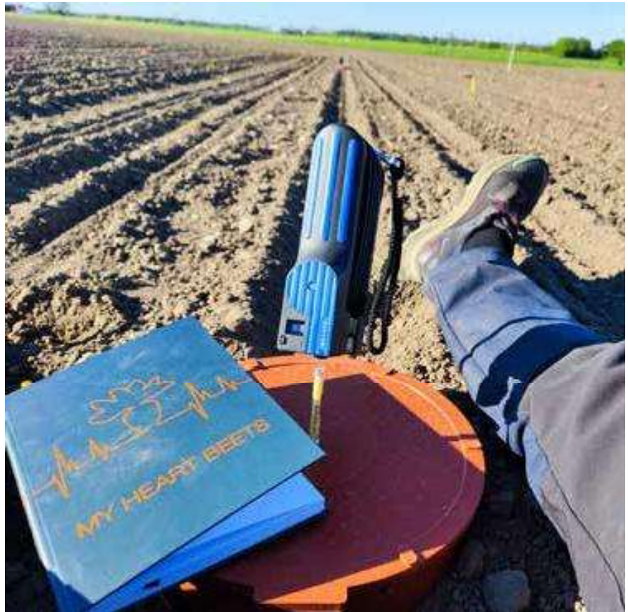
Ny metodik. Mätning av ammoniakavgång med gasdetekteringsrör.
